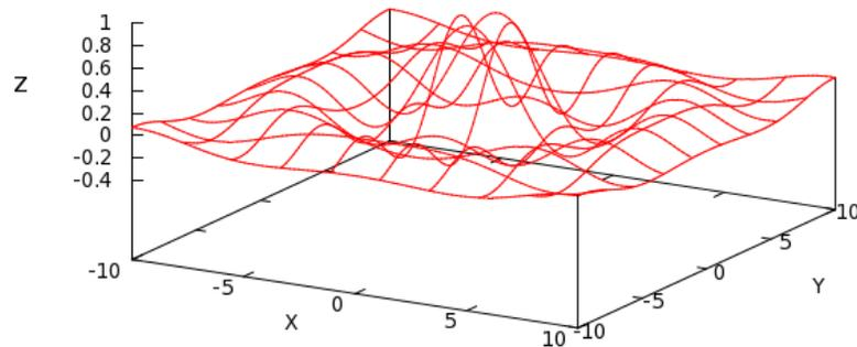
显然, 默认的网络有点过大, 无法显示函数细节。这个网格大小可以通过 `isosamples` 参数来调节。另外, 底部平面似乎离曲面太远了, 留了很大一段空白, 我们想把这个空白缩小一些。底部平面的位置由 `xyplane` 参数来控制, 可以用:
