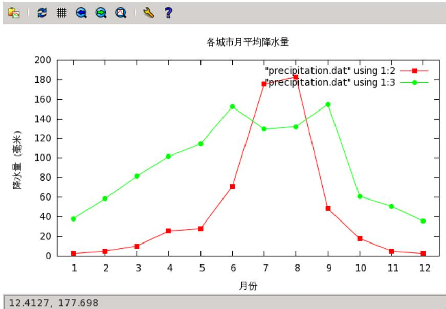
这里我们用了一个新的命令：`using`。在我们的数据文件包含超过一组数据时，我们可以用 `using` 指定使用哪列数据。例如 `using 1:2` 表示使用第一列和第二列数据，第一列为横轴，第二列为纵轴。以此类推，`using 1:3` 表示使用第一列和第三列数据。如果想把多组数据绘制到一个图上，只要使用一个 `plot` 命令，后面跟多组数据，每组数据之间用逗号隔开就可以了。
