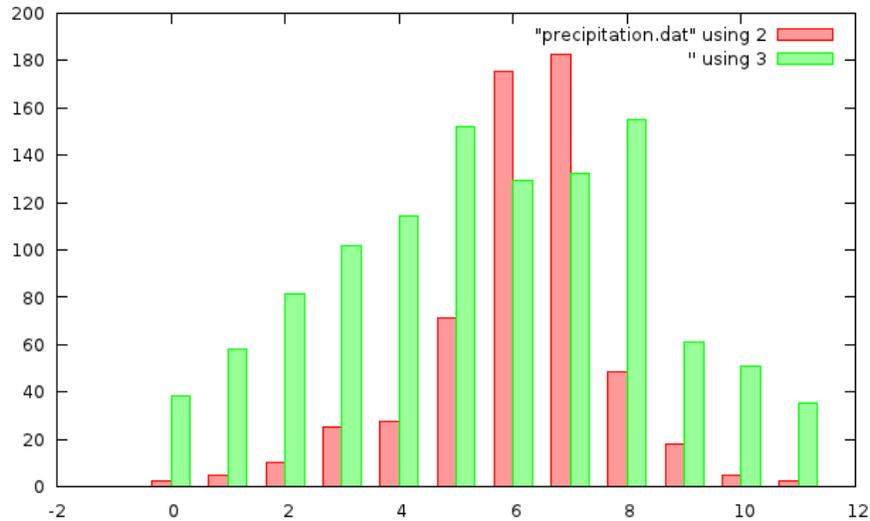
`set style data histogram` 命令告诉 `gnuplot` 所有数据绘图都使用 `histogram` 风格。`set style histogram` 命令设置 `histogram` 作图的参数，例如 `clustered` 模式就是像上图那样，把几组数据并排画在一起，`gap 1` 就表示各簇数据之间空白的宽度等于数据柱宽度的 1 倍。填充风格命令 (`set style fill`) 上次我们已经介绍过了。
