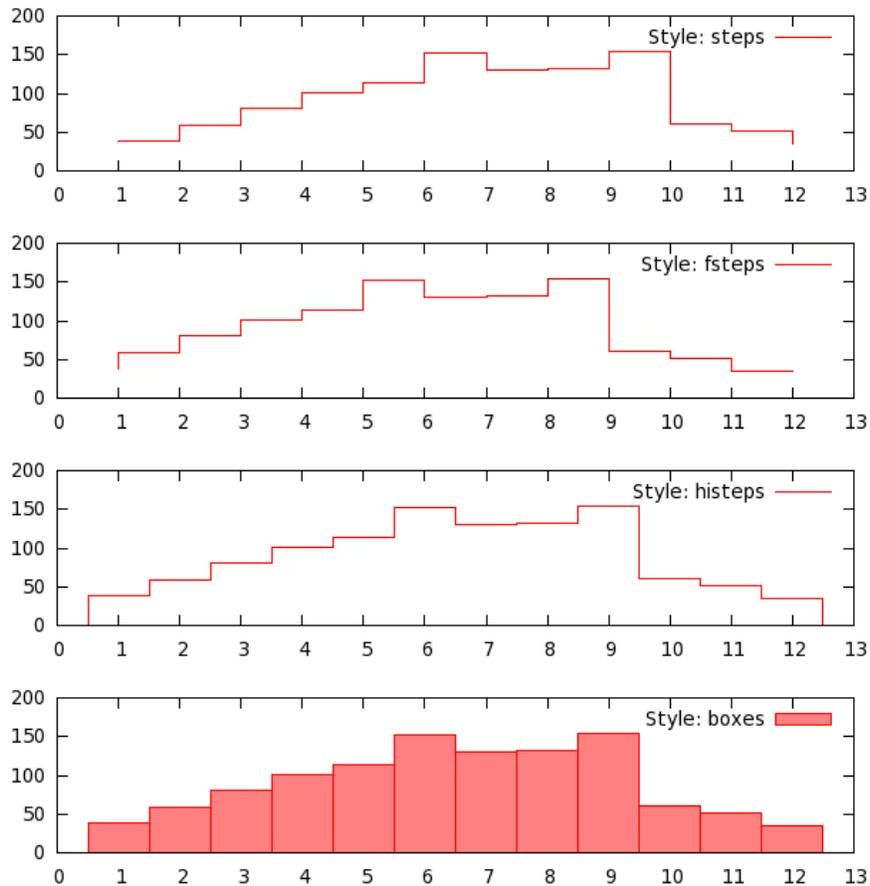
我们可以看出，三种 steps 作图方式基本相同，只是在 X 轴方向上略有平移。steps 曲线先沿 X 方向前进，再沿 Y 方向前进；fsteps 曲线先沿 Y 方向前进，再沿 X 方向前进。虽然我们有 12 个数据点，但是 steps 和 fsteps 都只有 11 段表示 Y 值大小的横线。histeps 和 steps 类似，但是起始点前移了 0.5 个单位长度，因此 histeps 具有全部 12 段表示 Y 值大小的横线。这三种 steps 方式都不具有填充风格。boxes 和 histeps 几乎完全相同，不同点在于 boxes 可以使用填充风格。另外，boxes 的柱宽可以通过 set boxwidth 命令调节。
