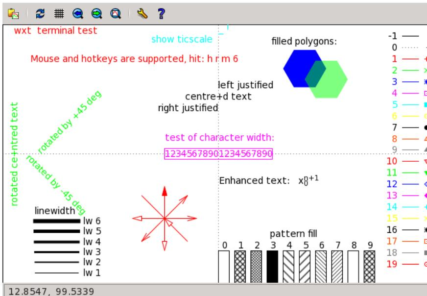
测试图中包含当前 terminal 的风格代码实例。例如，左下角显示的是连线粗细，右边显示的是色彩和数据点显示风格对应代码。
