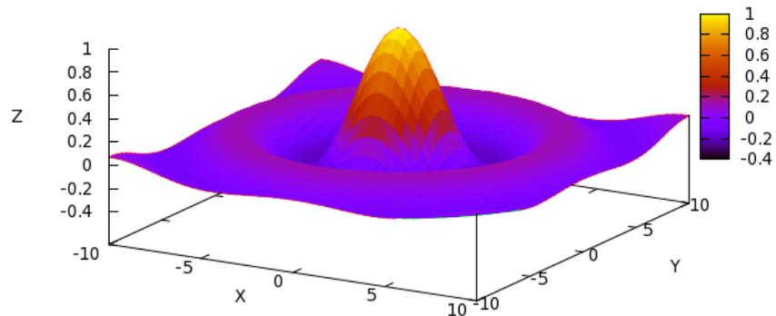
最后，既然是 3D 图像，就要涉及视角问题。gnuplot 里的 3D 视角用 set view 命令控制，默认视角是 60, 30，分别表示绕 x 轴和 z 轴的旋转角度。另外，一些 terminal 例如 wxt，支持直接用鼠标拖动图像改变视角。
