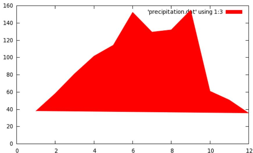
这里的 `filledcurves` 是一种新的画图风格，它会在数据（或函数）曲线中填入指定颜色。默认情况下，曲线是自我封闭的（closed），所以这里的例子中首尾数据点被连接了起来。
