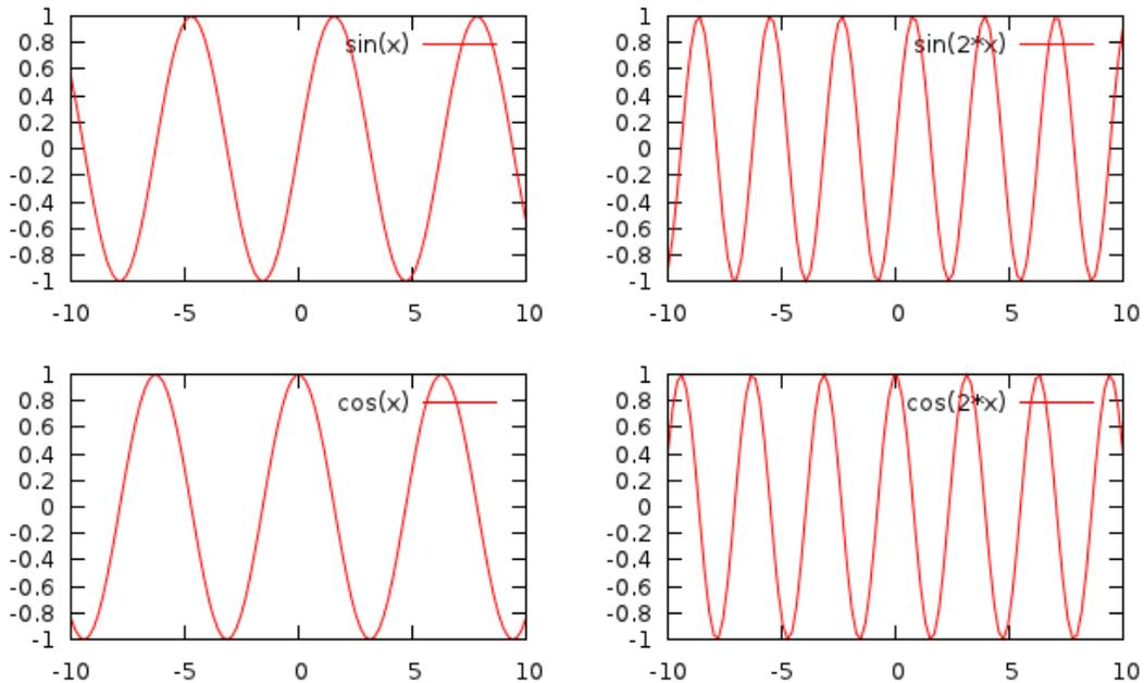
set multiplot 命令告诉 gnuplot 进入多图模式，这时候我们画的所有图像都会出现在同一张画布上。如果不做调整，所有图像将重叠在一起；如果适当调整每个图像的位置和大小，图像将按我们的要求排列起来。layout 参数可以自动将几幅图按照指定格式排列起来，例如这里的 4 幅图排成了  $2 \times 2$  的格式。最后，unset multiplot 命令退出多图模式。之前我们用过的绘图命令在多图模式下都有效，包括将图片输出为不同格式。
