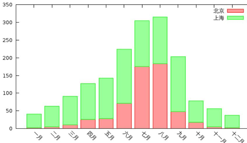
rowstacked 模式没有 gap 参数, 我们这里使用 set boxwidth 命令设置数据柱相对宽度。同时, X 轴标注被旋转了 45 度。这在柱状图里很常见, 因为密排的柱状图往往没有足够的空间显示 X 轴标注, 旋转之后显示空间便增大了。
