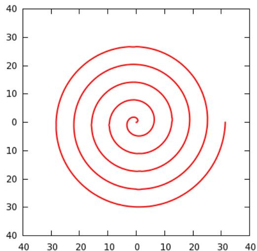
极坐标下的栅格和直角坐标不同，应该是按一定角度分隔的扇区，所以 `set grid` 命令需要加上 `polar` 参数。默认扇区分隔角度是 30 度，该角度可以作为 `set grid polar` 的参数进行调整:
