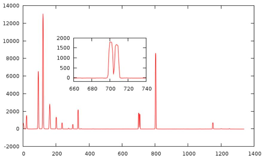
这里我们绘制了一组光谱数据 (spectrum.dat)，并且把 [660, 740] 这个区间内的数据单独绘制出来，嵌套在大图内，用于更清楚的展示细节。这里的 `set origin` 命令用于设置绘图的原点，`set size` 命令以前已经讲过，用于设置图像大小。这两个命令均使用 `screen` 坐标系统（参考之前的博文：“[坐标系统及标签](#)”）。开始处的 `reset` 命令正如它的名字所暗示的那样，用于让人工设置的参数恢复至默认值。
