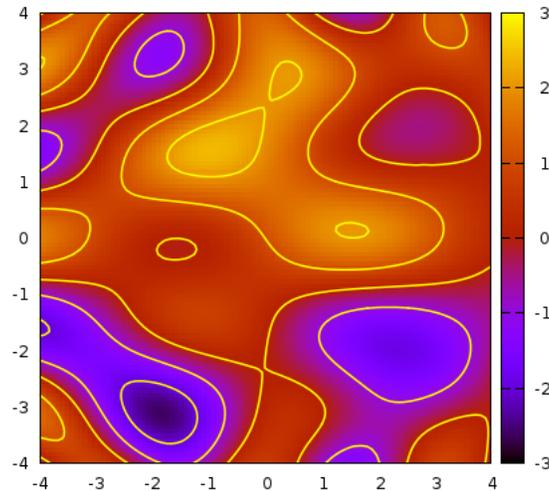
这里我们预先把等高线图以 table 格式存入了 cont.dat 文件，随后用 plot 命令调用该文件，把等高线画在了 surface.dat 数据的 image 图上（注意：不是 pm3d 图）。这里我们可以用 plot 命令的图线风格参数控制等高线的粗细和颜色。
