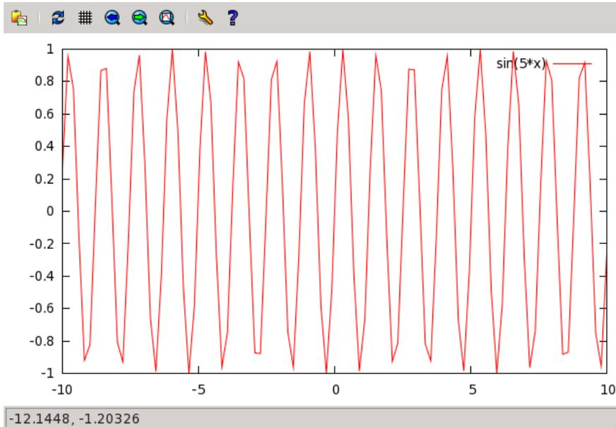
这个正弦函数看着有点别扭，是吧？这是因为 gnuplot 默认的函数取样为 100 个点，对于快速振荡的函数，这个取样率有点低。函数取样数目由 `samples` 这个参数控制。在 gnuplot 里面，所有参数赋值都由 `set` 命令完成。我们把函数取样数目改为 500：
