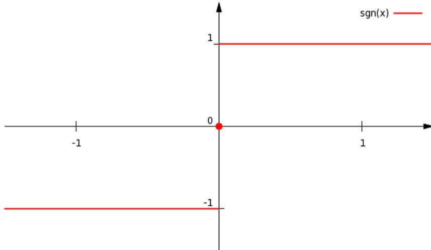
这里我们用 `plus(x)` 和 `minus(x)` 分别表示函数的正值和负值部分，用 `1/0` 表示函数值没有定义。在零点，我们利用一个不含任何字符的 `label` 命令画一个独立的点。以前我们讲过 `label` 命令，这里的 `label` 命令有两个新的参数：`point` 参数允许在 `label` 所在坐标画一个点；而 `front` 参数表示将 `label` 放在前景，这样它就不会被图像其他部分遮盖，类似于图形处理软件中调整 `layer` 的顺序。和 `front` 类似的参数还有 `back`。
