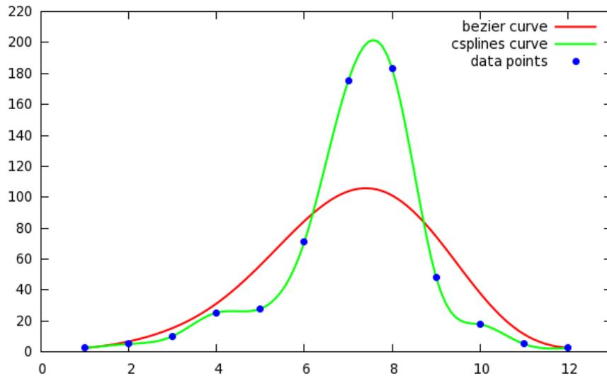
这里有两种平滑算法：bezier 和 csplines，分别对应上述两个类别。smooth 默认使用 lines 风格绘图。
